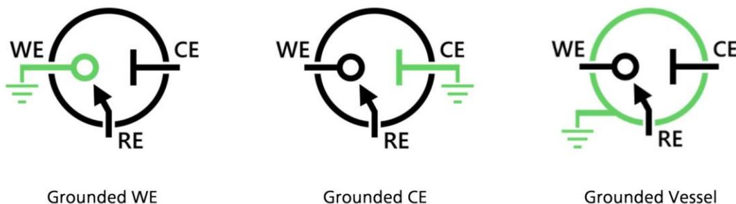
Рисунок 31. Графическое представление различных типов заземленных ячеек с точкой заземления.
